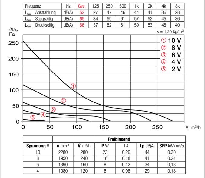
**Energiesparender EC-Rohrventilator mit hoher Druck- und Volumenleistung bei raumsparenden Abmessungen.**
