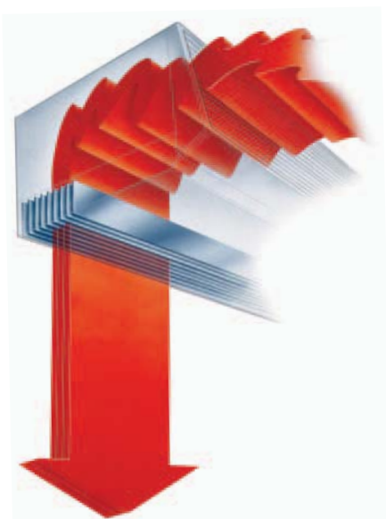
A szabadalmaztatott párhuzamosító megakadályozza a turbulenciát.
