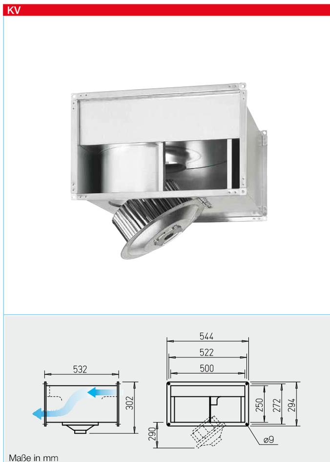
Radial-Kanalventilatoren mit vorwärts gekrümmten Laufradschaufeln. Motor-Laufradeinheit ausschwenkbar.
