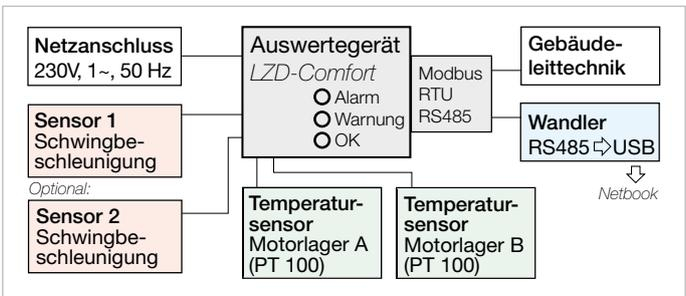
Die Helios Lager-Zustandsdiagnostik ist ein System zur Sicherstellung der Funktionsfähigkeit von Motorlagern auch nach längerem Stillstand, wie es bei Helios Brandgasventilatoren der Fall sein kann. Das System überprüft den Zustand der Motorlager und wertet diesen aus. Die Ergebnisausgabe erfolgt direkt im Ampelprinzip zur schnellen Erfassung vor Ort oder durch die optionale Einbindung in die Gebäudeleittechnik.
