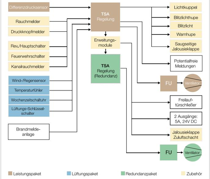
Treppenhaus-Spüllüftungsanlagen mit geregelter Druckhaltung realisieren im Brandfall eine Verdünnung und Ausspülung der in den Rettungsweg eingedrungenen Brandgase. Zusätzlich wird durch den Aufbau eines geregelten Differenzdrucks ein weiterer Raucheintrag in den Rettungsweg verhindert.
