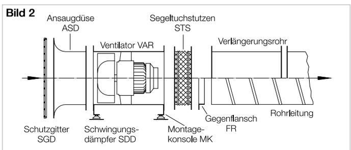
**□ Horizontale Montage mit Schalldämpfer**
