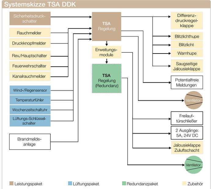
Treppenhaus-Spüllüftungsanlagen mit geregelter Druckhaltung realisieren im Brandfall eine Verdünnung und Ausspülung der in den Rettungsweg eingedrungenen Brandgase. Zusätzlich wird durch den Aufbau eines geregelten Differenzdrucks ein weiterer Raucheintrag in den Rettungsweg verhindert.
