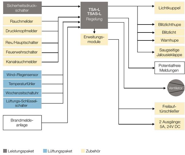
Helios Treppenhaus-Spüllüftungsanlagen sorgen im Brandfall durch Ausspülung für eine deutliche Verdünnung der Rauchgaskonzentration in Treppenträumen und erhöhen dadurch die Chancen auf eine schnelle und erfolgreiche Eigenrettung.
