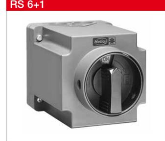
Spannung 400 V, 3~, 50/60 Hz. Schutzart IP 65. Schutzklasse II. Betätigung Drehantrieb. Verriegelungsmögl. „0 OFF“ und „I ON“. Temperaturbereich -25 bis +60 °C. Gehäuse UV- und Witterungsbeständig. Schaltplan-Nr. 1088.
