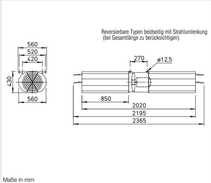
**Hochwertige, leistungsstarke Impulsventilatoren mit optimalen Abmessungen für geringsten Platzbedarf. Geeignet zur Be- und Entlüftung von Parkgaragen mit Fördermitteltemperaturen von bis zu 60 °C.**
