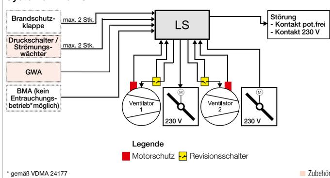
der Garagen-Lüftungssteuerung aufgelegt werden. Für Motoren ohne Thermokontakt oder Kaltleiter verfügt die Garagen-Lüftungssteuerung über Motorschutzschalter bzw. -relais. Bei Auslösung der Motorschutzeinrichtungen erfolgt eine Störmeldung, die nach Ursachenerkundung über den Drehschalter für die Betriebsart entriegelt werden kann.
