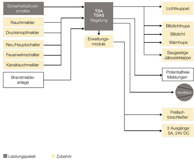
Helios Treppenhaus-Spüllüftungsanlagen sorgen im Brandfall durch Ausspülung für eine deutliche Verdünnung der Rauchgaskonzentration in Treppenträumen und erhöhen dadurch die Chancen auf eine schnelle und erfolgreiche Eigenrettung.
