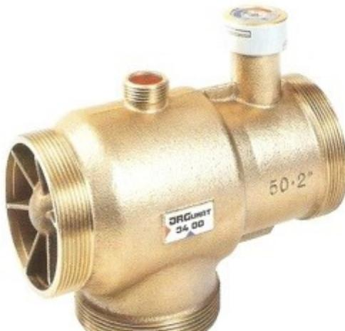
**3400** *JRGUMAT® Thermomischer aus Rotguss, allseitig Aussengewinde für Verschraubungen, für Wasser PN 10 und max. 90 °C, vom Werk auf eine Standard-Temperatur eingestellt.*
